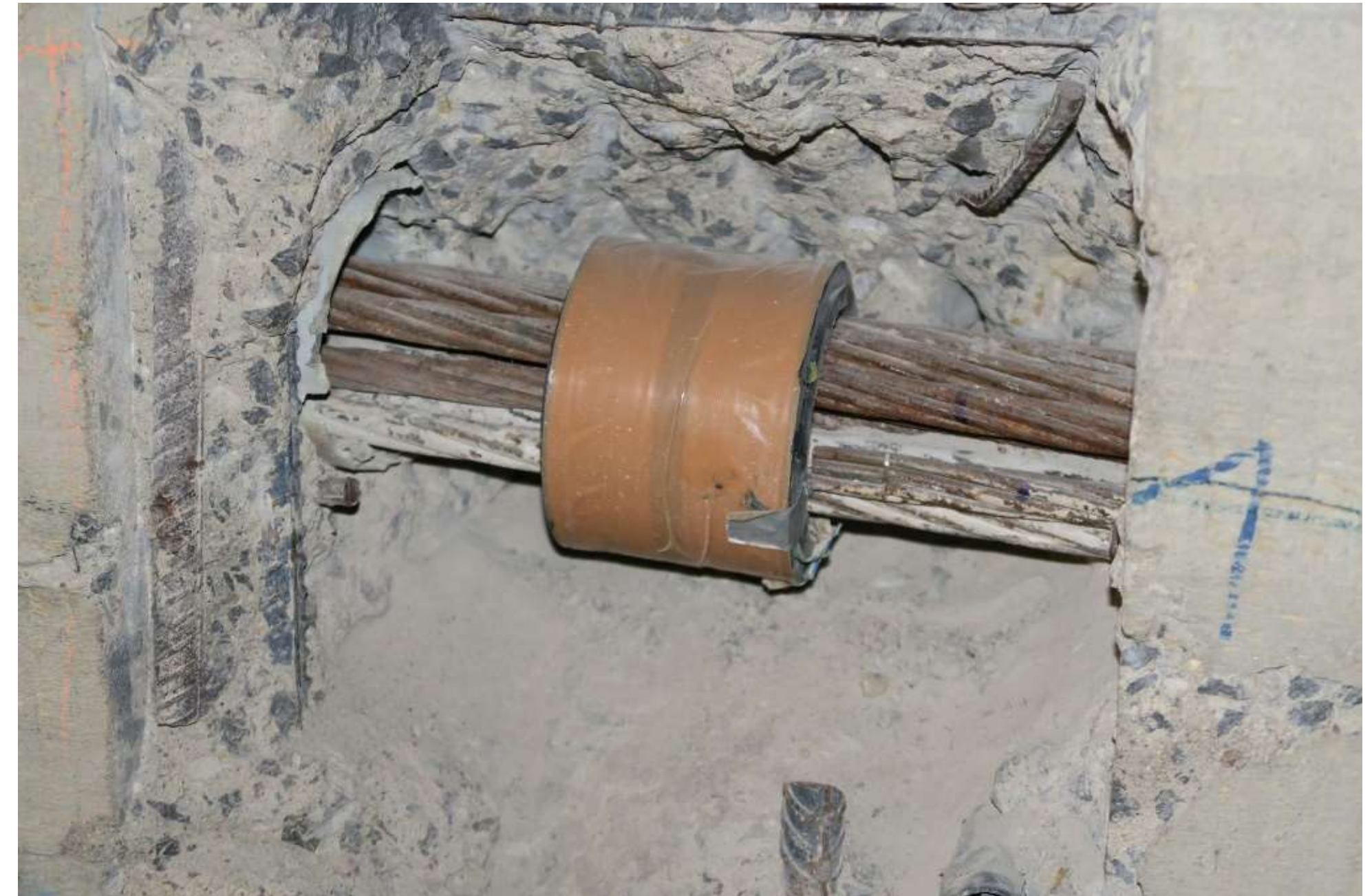
Magneto-elastické senzory pro měření napětí v předpínacích kabelech
